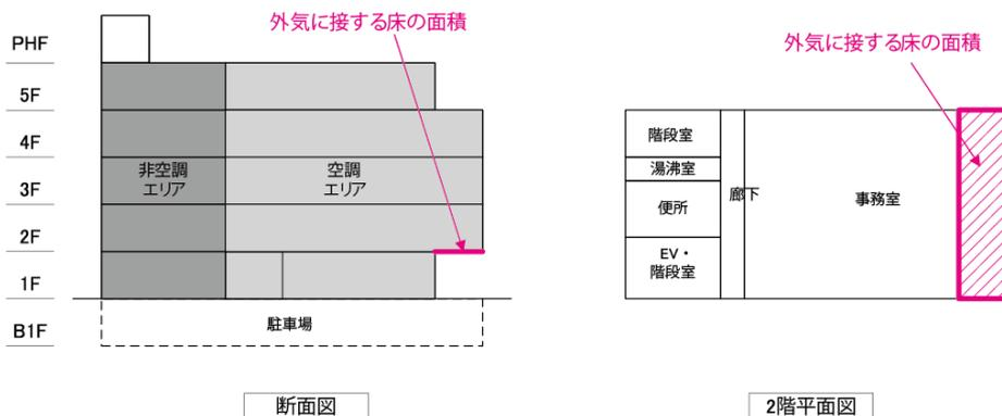
図 2-2-18 外気に接する床の面積の考え方
