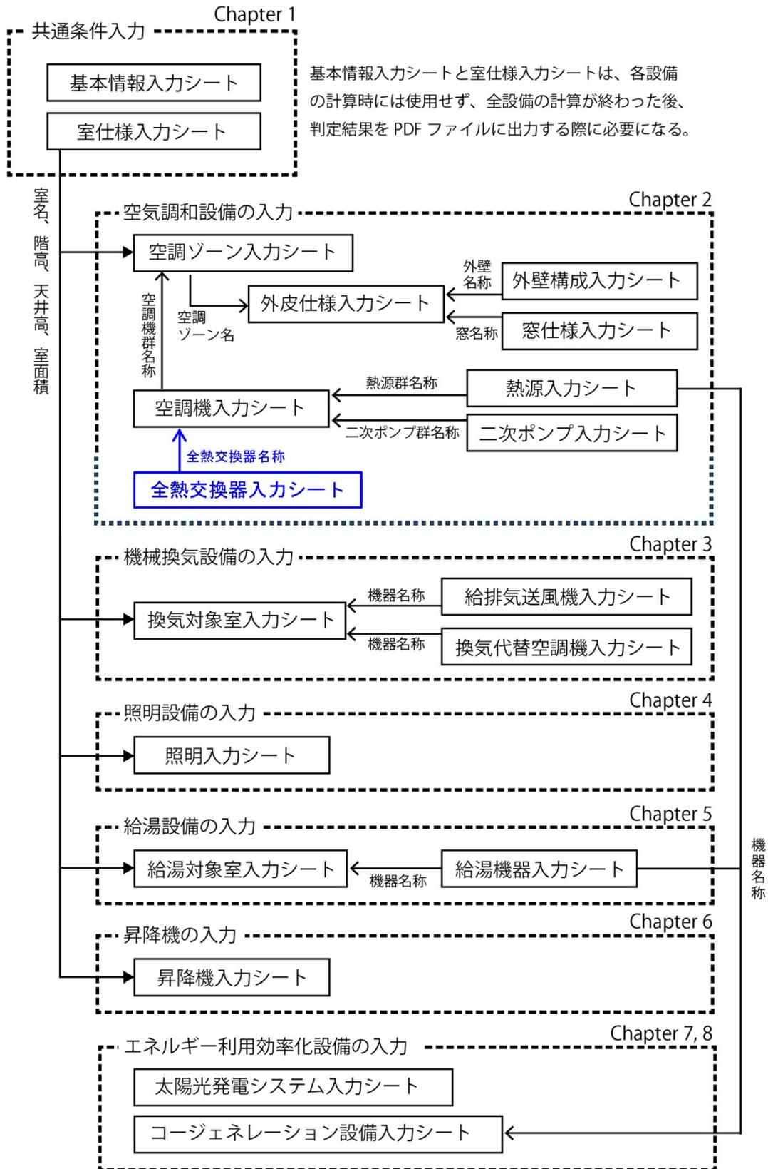
図 0-3-1 外皮・設備仕様入力シートの構成
