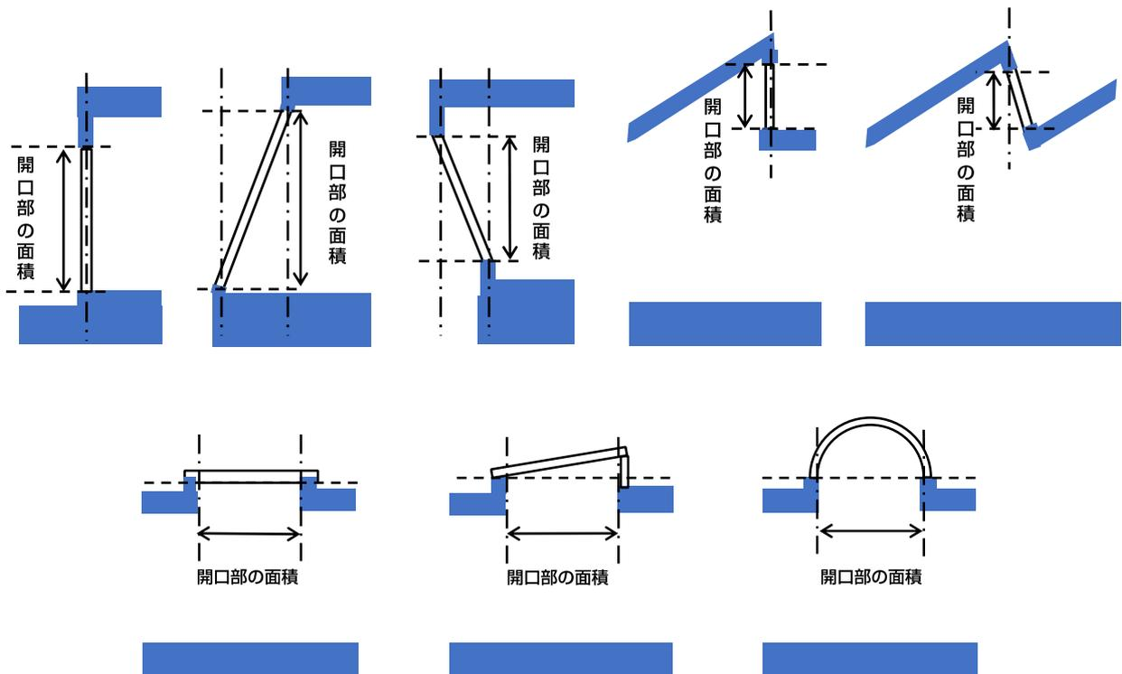
図 4-1-3 開口部の面積の算出例
